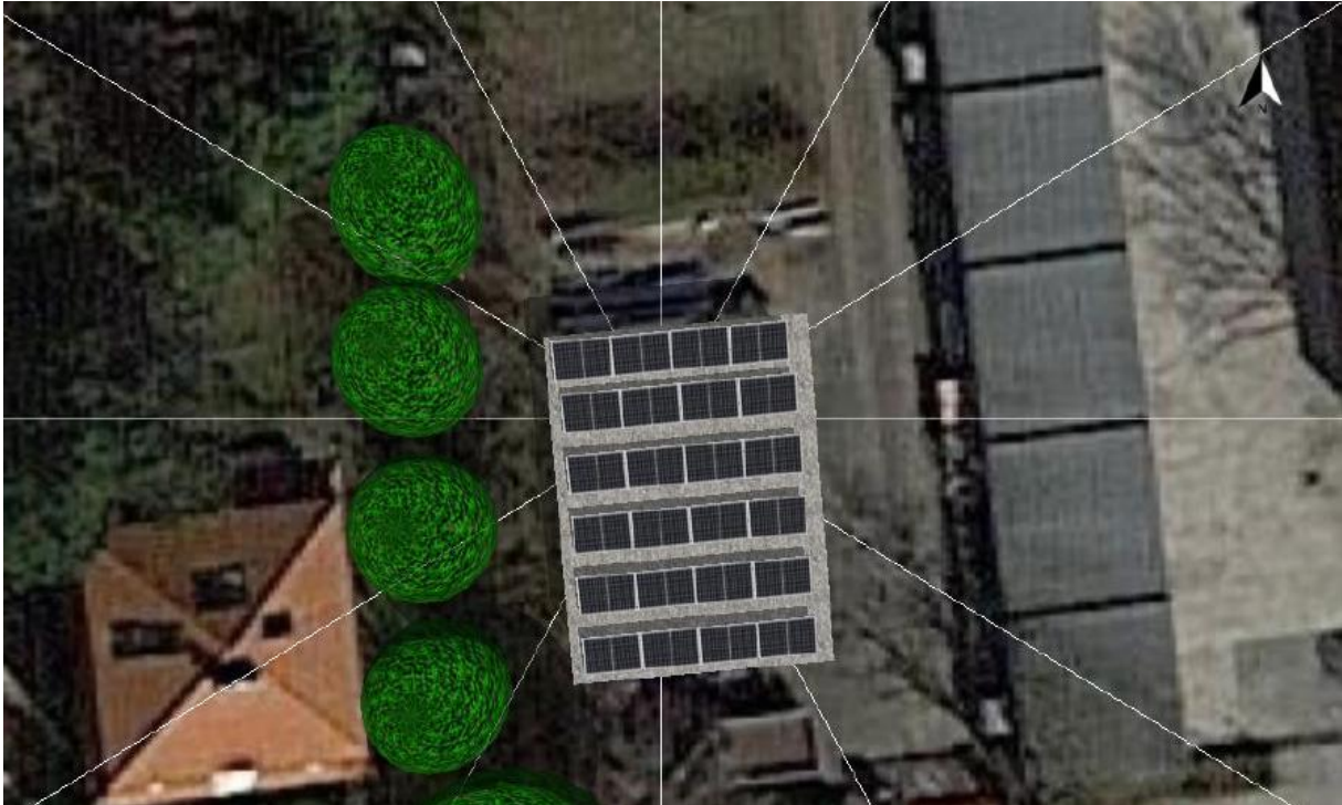
Abbildung 4.3: Geplante PV-Anlage Wasserwerk Mödling - Pumpwerk Quellenstraße
